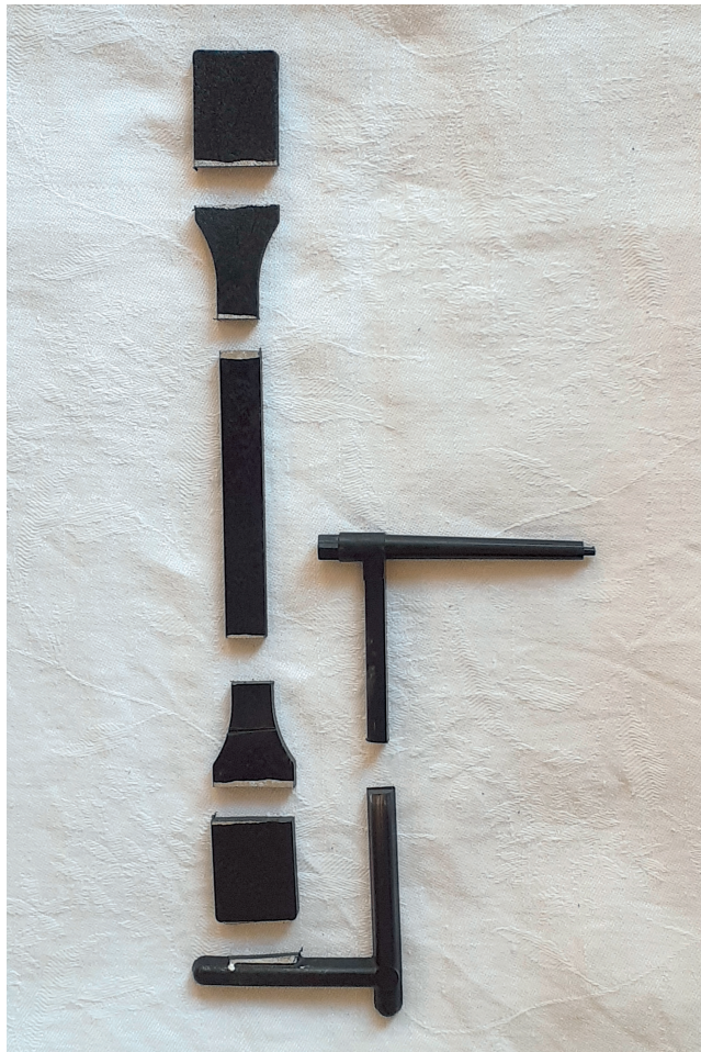
Bild 1. Prüfstab inklusive Anguss aus PA: Die Segmente wurden bewusst gewählt, um den Einfluss von verschiedenen Verarbeitungsbedingungen auf den Fasergehalt zu untersuchen.
